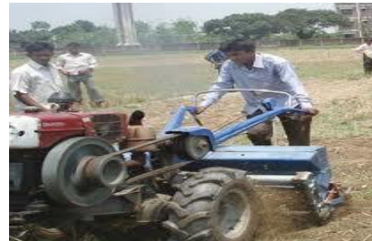
(d) Digging the dry land by Powertiller
