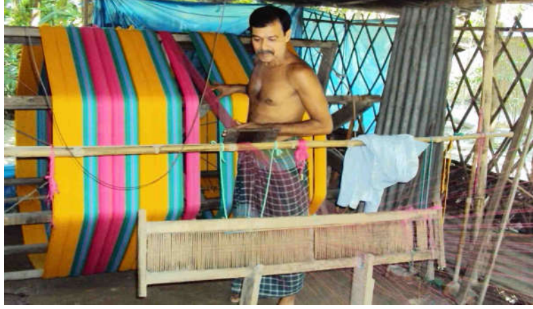
কাঠের ড্রামের মাধ্যমে বীম তৈরি (বুননের কাজে ব্যবহৃত হয়)
