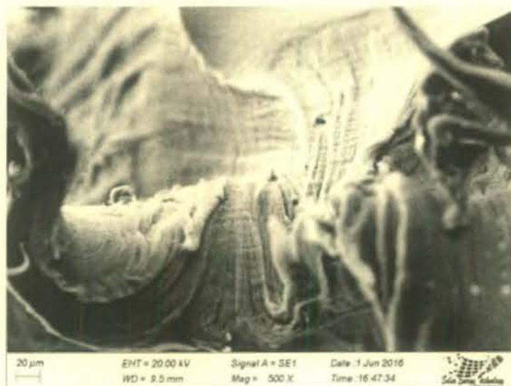
Figure 9.10: Image of 5% ALS + 95% LDPE composite.
