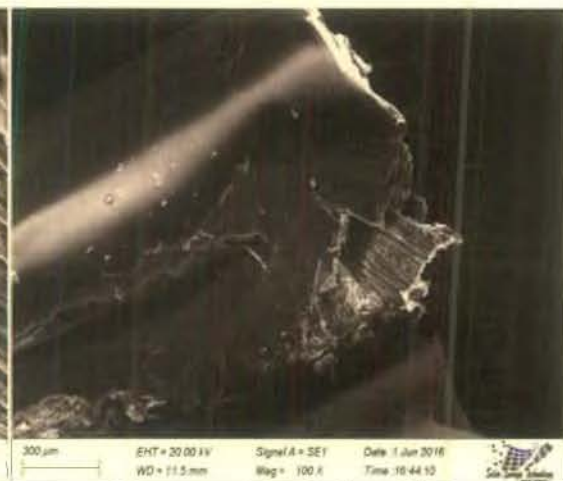
Figure 8.5: 10% ALS fiber + PP/PVC (55% + 45%) mixed hybrid composites.
